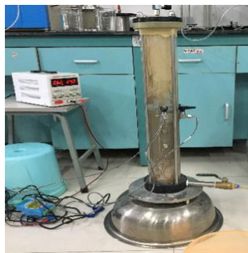
(b) 浮力试验装置图
